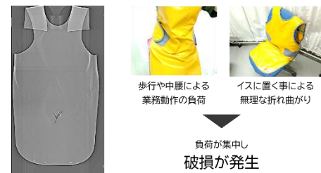
Fig.8 結果 1 の防護衣破損原因
