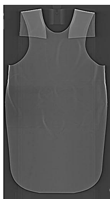
Fig.1 CT による防護衣点検の特徴
