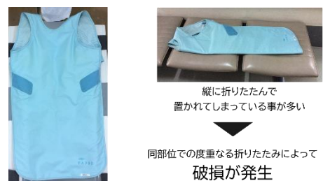
Fig.9 結果 2 の防護衣破損原因
